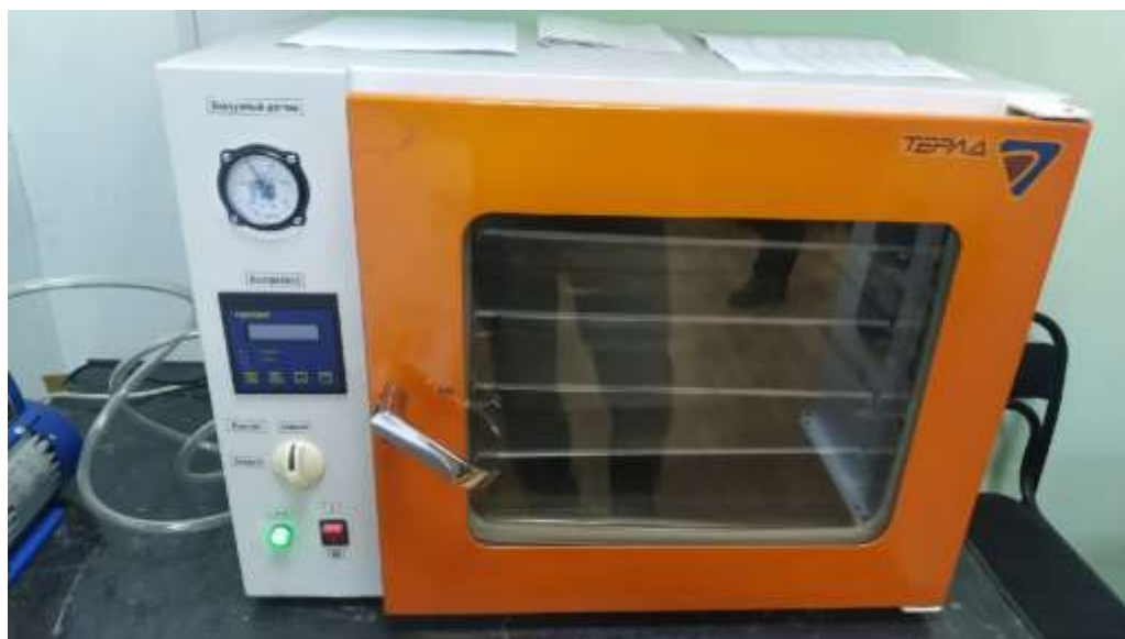
Рис. 4. Печь для удаления замасливателя с углеродной ткани
