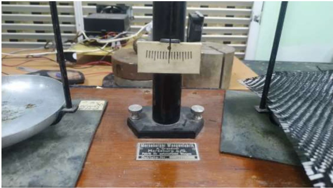
Рис. 2. Взвешивание матричного и армирующего слоев перед формированием
