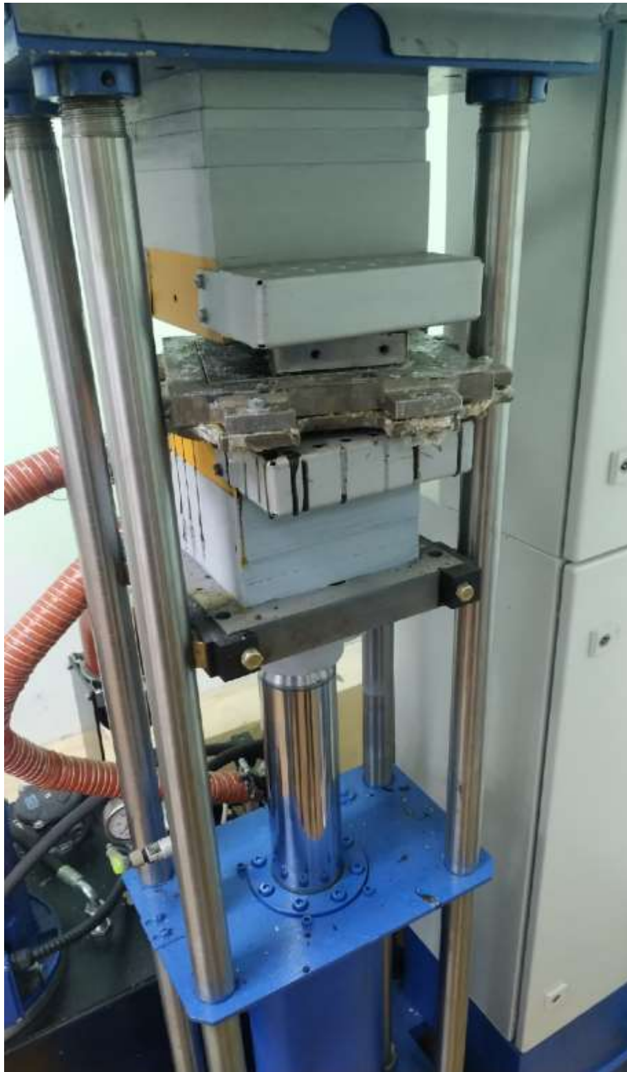
Рис. 5. Пресс с установленной пресс-формой
