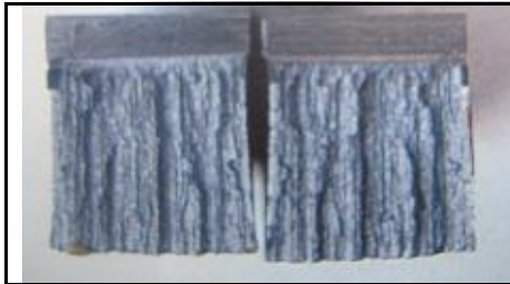
Рис. 13. Шиферный излом на образцах, после разрушения ударной нагрузкой
