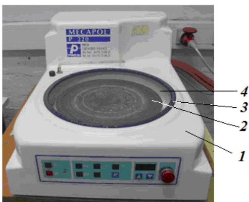
Рис. 2П1. Шлифовально-полировальный станок:
