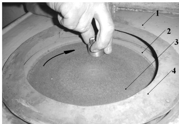
Рис. 3П1. Рекомендуемый прием шлифования и полирования шлифа на полировальной установке: 1 – стол полировальной установки; 2 – диск; 3 – шкурка или сукно; 4 – защитный кожух
