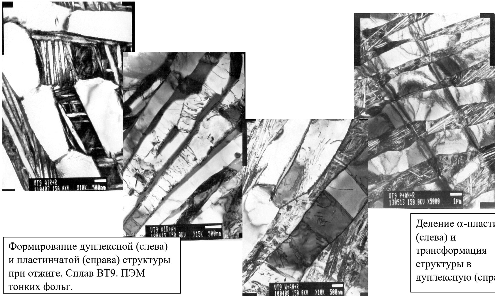
Формирование дуплексной (слева) и пластинчатой (справа) структуры при отжиге. Сплав ВТ9. ПЭМ тонких фольг.
