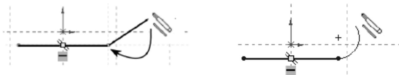
Рис. 2.5. Автоматический переход от линии к касательной дуге
