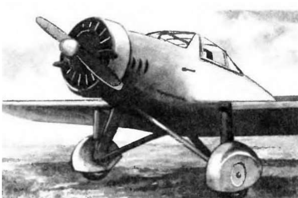
Рис. 1.1. Первый в мире четырехместный самолёт из магниевых сплавов ЭМАИ-1 «Серго Орджоникидзе» (1934 г.)
