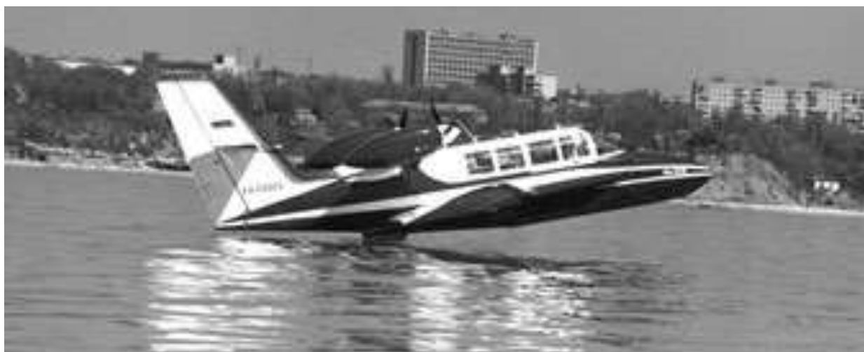
Рис. 3.6. Гидросамолет Бе-103, обшивка из листов сплава 1441
