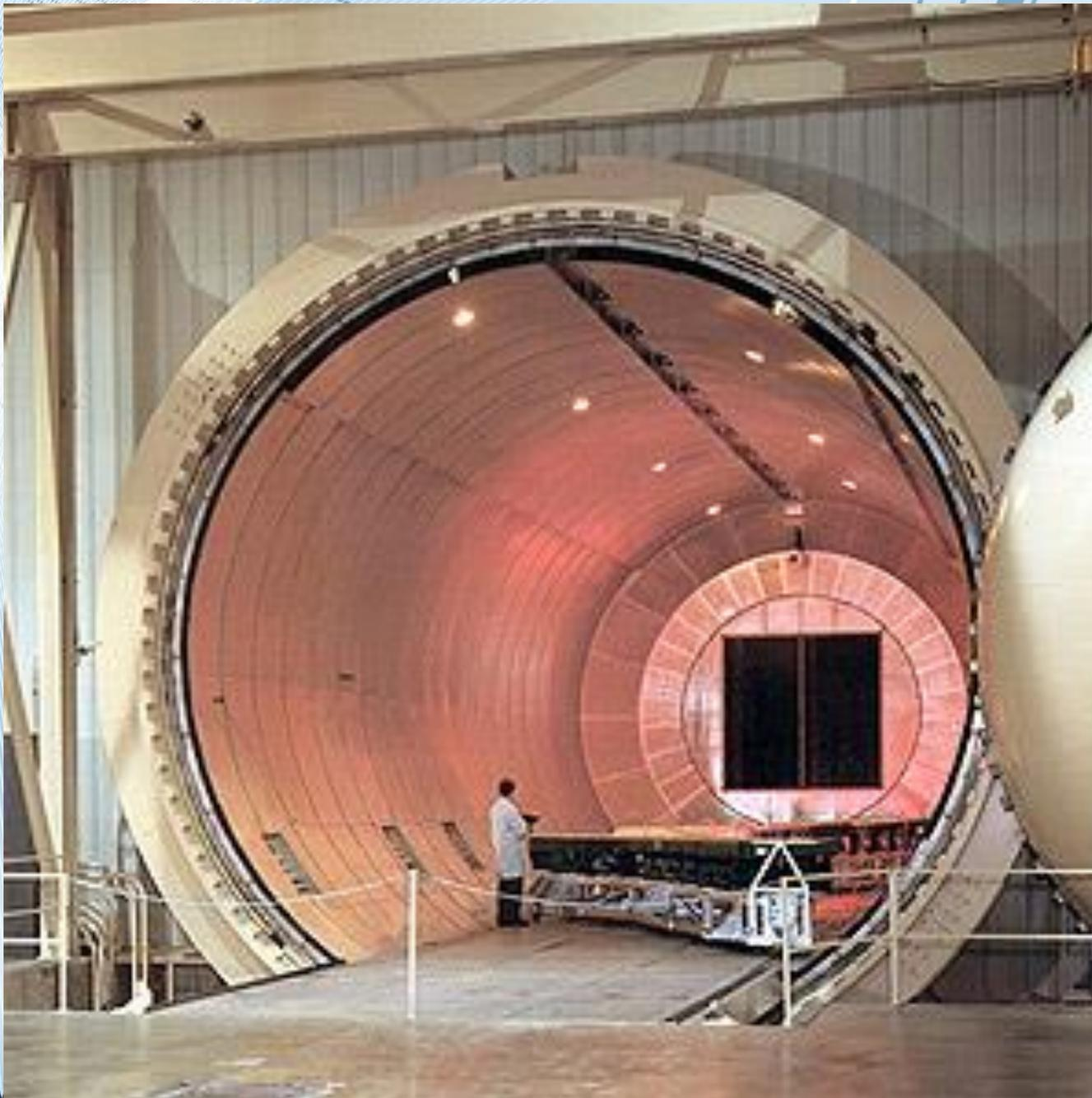
Автоклав для производства фюзеляжа самолета БОИНГ-787; диаметр фюзеляжа около 5,77 м; диаметр автоклава более 8 м; длина фюзеляжа в зависимости от модификации самолета варьируется от 55,5 м до 68,9 м.
