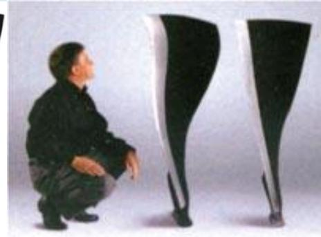
В двигателе фирмы General Electrics для пассажирского самолета корпус и лопатки вентилятора изготовлены из композиционных материалов; длина лопаток составляет около 1,5÷1,625 м; диаметр вентилятора соответственно 3÷3,25 м; такие лопатки в 8 раз легче, чем аналогичные цельные титановые и на 10 % легче чем аналогичные пустотелые титановые.
