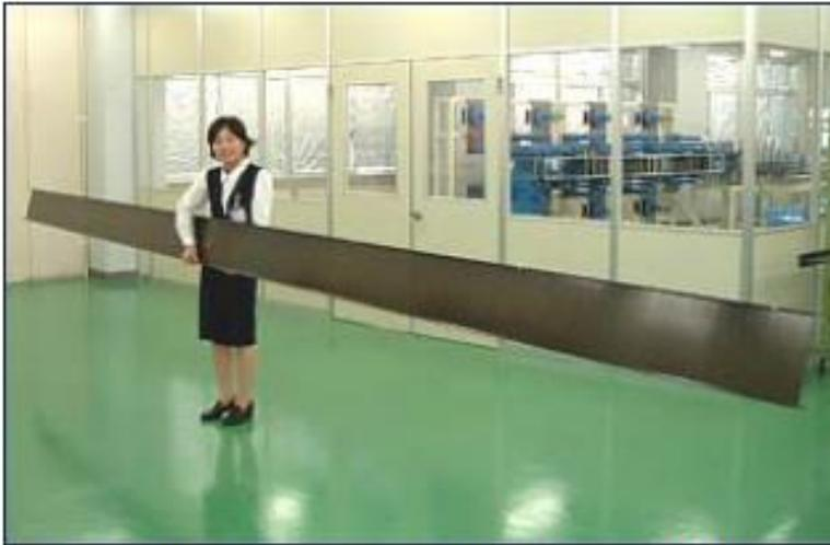
Стандартный профиль из композита, полученный методом пултрузии
