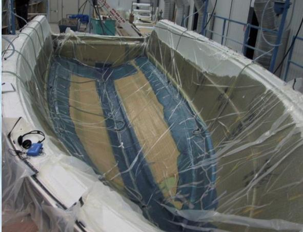
Ручная выкладка слоев корпуса судна
