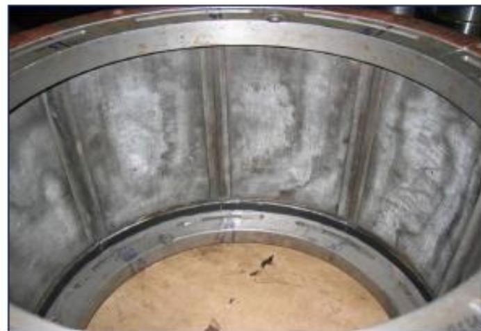
Подшипник вала гидротурбины (ФУТ)
