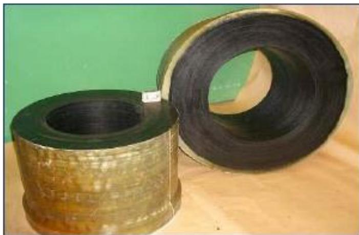
Подшипник гребного вала валопровода судна
