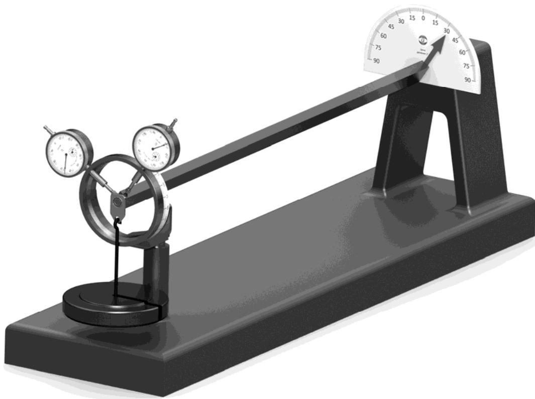
*Рис. 4. Установка для испытаний на косо́й изгиб*
