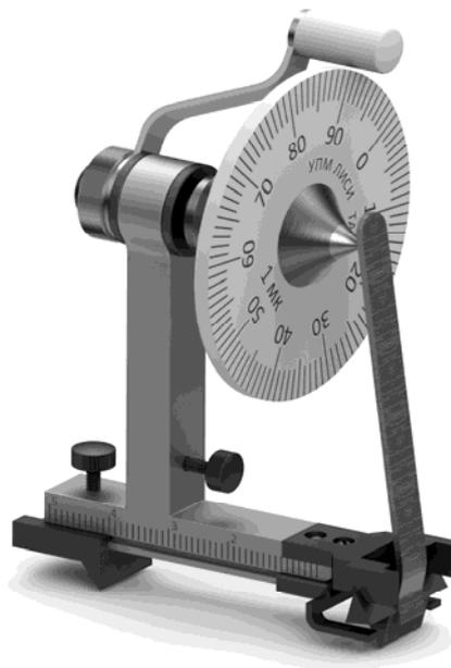
Рис. 4. Тензометр системы Н. Н. Аистова
