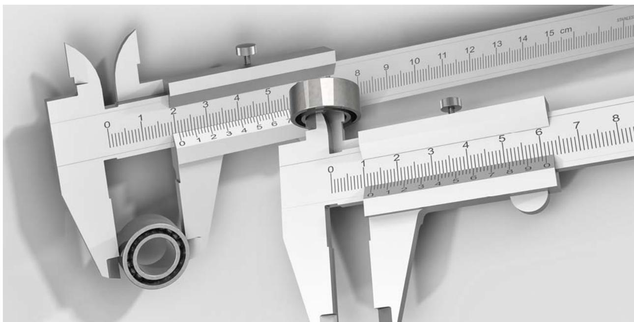
Рис. 1. Измерение внешних и внутренних размеров с помощью штангенциркуля
