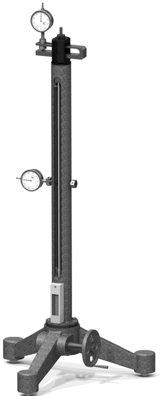
*Рис. 6. Установка для испытаний материала на устойчивость*
