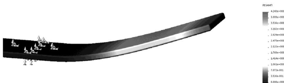
Рис. 3. Амплитуды перемещений тарировочной балки
