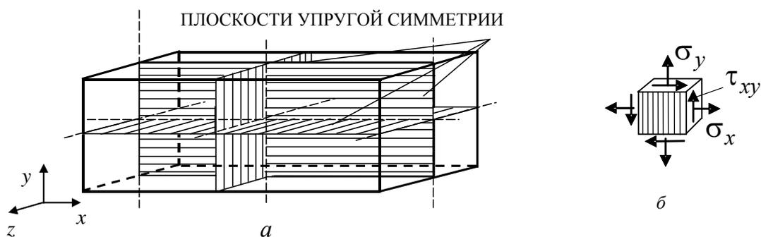
Рис. 5.3. Тело, имеющее три плоскости упругой симметрии (а), ортотропный элемент при плоском напряженном состоянии (б)
