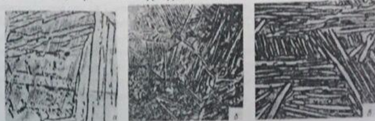
Рис. 2. Структуры титановых сплавов: а) твердый раствор \alpha (сплав ВТ1); б) фаза \alpha' (мартенсит, полученный после закалки сплавов ВТ1 с 1075°С); в) твердые растворы \alpha+\beta (сплав ОТ4).
