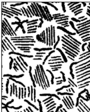
Рисунок 5 – Схема микроструктуры серого чугуна
