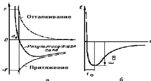
Оценим энергию потенциального взаимодействия двух атомов как работу с обратным знаком при перемещении иона из бесконечности в  $r_0$ . Геометрическое интегрирование дает значение, показанное на рисунке 1.1 б. Из рисунка видно, что минимальной энергии потенциала взаимодействия соответствует расстояние между соседними ионами, равное  $r_0$ . Увеличение энергии системы двух атомов (например, за счет тепловой энергии) ведет к появлению взаимного смещения атомов относительно друг друга.
