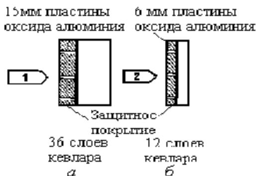
**Рисунок 6.4. Конструкция керамической бронепанели: а, б - составные элементы бронепанели для защиты от бронебойных пуль разного калибра; в - фрагмент бронепанели, собранной из элементов а и б; 1 - бронебойная пуля калибра 12,7 мм; 2 - пуля калибра 7,62 мм;**
