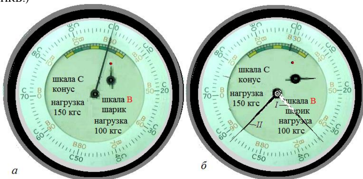
Рис. 3. П4. Индикатор прибора ТК-2: положение стрелок в зависимости от этапов испытания
