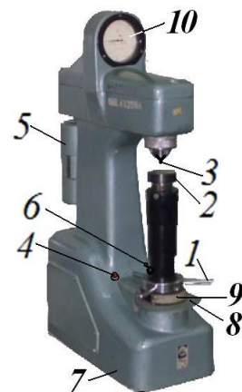
Рис. 2. П4. Твердомер Роквелла: 1 – штурвал; 2 – стол; 3 – индентор; 4 – сигнальная лампочка; 5 – груз; 6 – выключатель; 7 – станина; 8 – пе- даль; 9 – ободок ; 10 – индикатор
