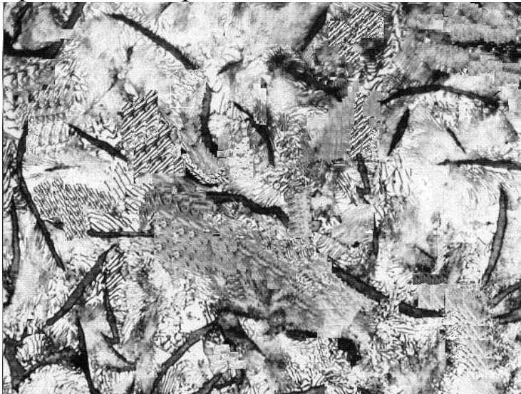
Рис. 5.5. Микроструктура модифицированного перлитного серого чугуна СЧ 30, x500
