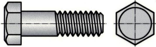
Болт для отверстий из под развертки
