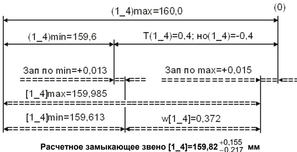
Рис. 2.22. Размерная схема исходного и расчетного замыкающих звеньев
