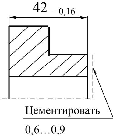
Дано: чертеж (эскиз) детали и план обработки (фрагмент). Представить технологический процесс в виде математической модели (в графической и аналитической формах) и определить значения технологических размеров  $l_1$ ,  $l_2$ ,  $C_T$  и  $l_4$ , обеспечивающих размеры, указанные на чертеже.
