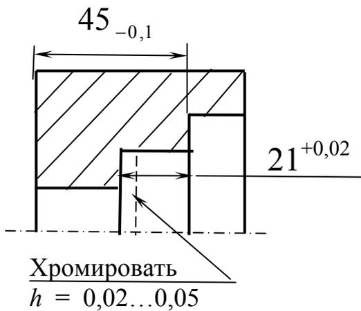
**Дано:** чертеж (эскиз) детали, план обработки (фрагмент). **Представить** технологический процесс в виде математической модели (в графической и аналитических формах) и **определить** значения операционных размеров  $l_1$ ,  $l_2$ ,  $l_3$ ,  $l_4$  и  $l_5$ , обеспечивающих размеры, указанные на чертеже детали.
