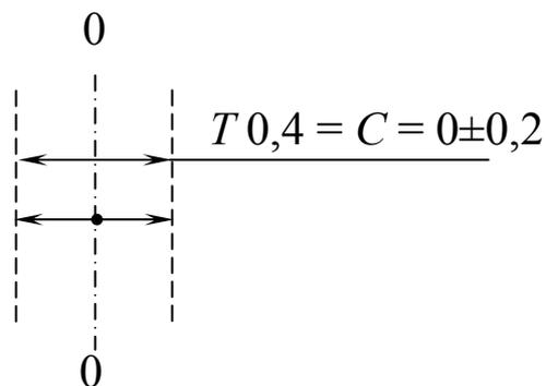
Здесь показано, что относительно некоторой нулевой линии 00, когда оси размеров 16 и 56 полностью совпадают (соосны), любая ось может занимать относительно ее любое положение (вправо, влево), но не далее чем на  $\pm 0,2$  мм. Наибольшее (предельное) отклонение соосности (C) размеров составит 0,4 мм. Это показано на совмещенной схеме.
