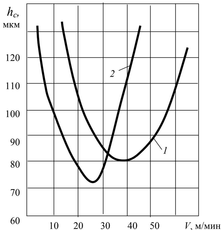
Рис. 3.2. Влияние скорости резания на глубину наклепа
