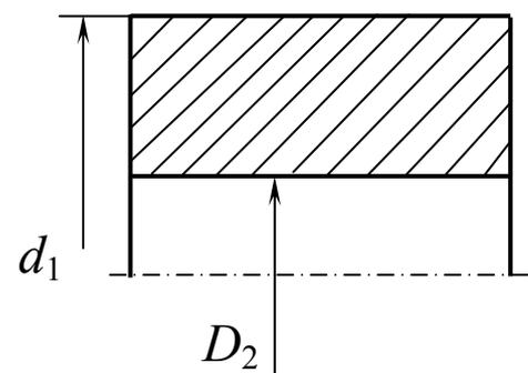
Допускаемое радиальное биение поверхностей  $D_1$  и  $d_2 - T_{v_0}$
