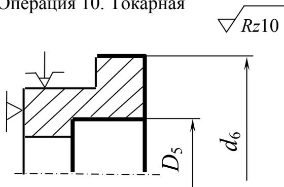
Допускаемое радиальное биение поверхностей  $D_5$  и  $d_6$  относительно базы  $Tv'_{10}$  и  $Tv''_{10}$
