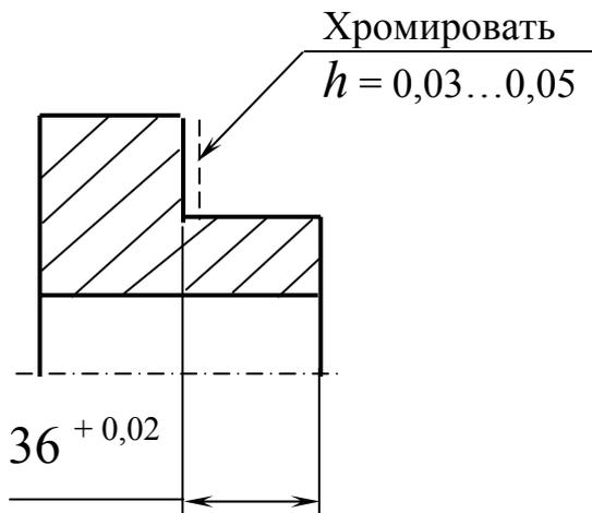
**Дано:** чертеж (эскиз) детали и план обработки (фрагмент).
