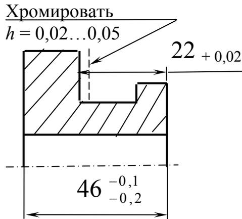
Дано: чертеж (эскиз) детали, план обработки (фрагмент). Представить технологический процесс в виде математической модели (в графической и аналитических формах) и определить значения операционных размеров  $l_1$ ,  $l_2$ ,  $l_3$ ,  $l_4$  и  $l_5$ , обеспечивающих размеры, указанные на чертеже детали.
