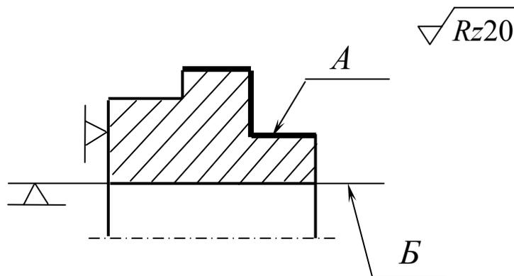
Биение поверхности *A* относительно поверхности *B* не более 0,1.
