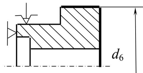
Допускаемое радиальное биение поверхностей  $D_3$ ,  $D_4$  и  $d_5$  относительно базы  $Tv_5'$ ,  $Tv_5''$ ,  $Tv_5'''$ .
