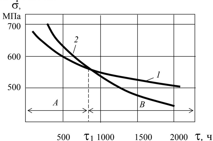
Рис. 3.4. Типичный характер кривых жаропрочности для никелевого сплава:
