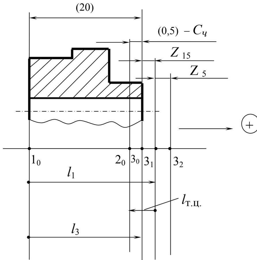
Рис. 1.11. Совмещенная схема технологического процесса
