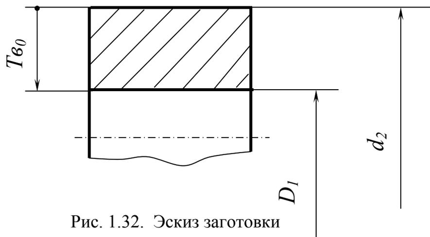
Рис. 1.32. Эскиз заготовки
