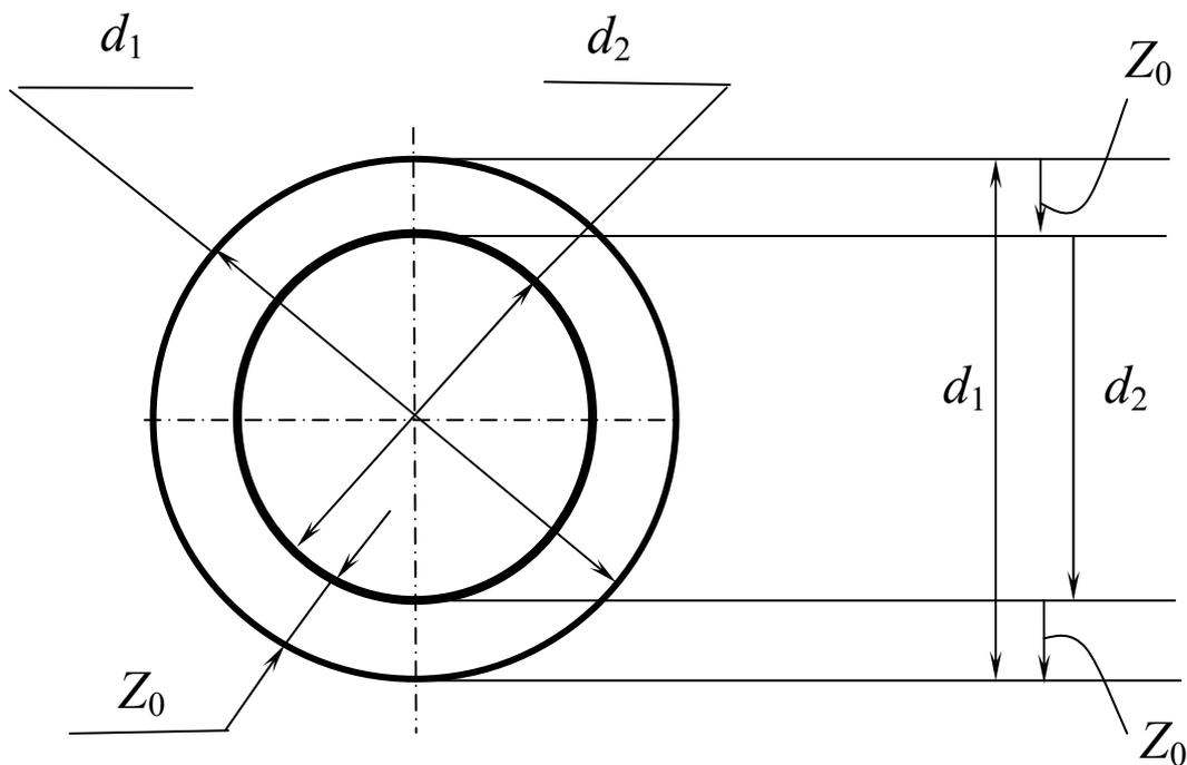
Рис. 1.26. К методике определения размера заготовки вала
