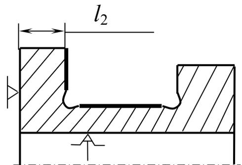
Операция 20. Цементация на глубину  $C_T$ , закалка
