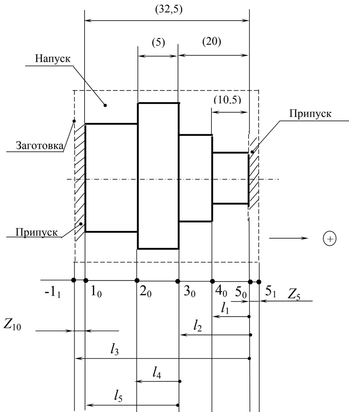
Рис.1.4. Совмещенная схема ГП
