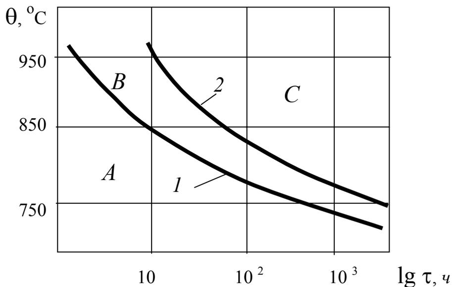
Рис. 3.5. Температурно-ресурсные зоны (блокирующие контуры) работоспособности никелевого сплава в зависимости от технологии обработки поверхности
