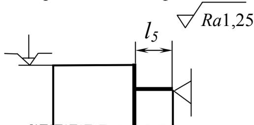
С цементированных поверхностей допускается снимать припуск не более 0,2 мм
