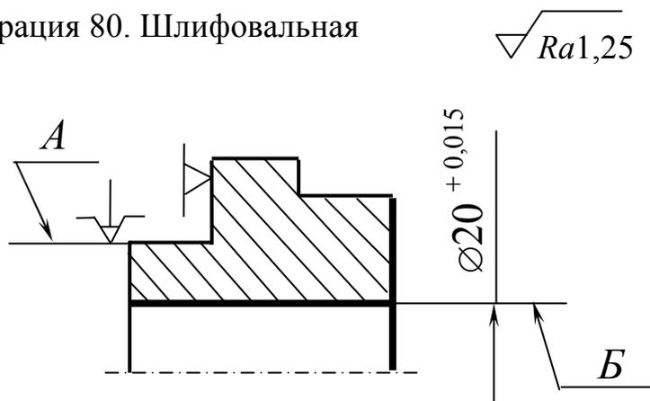
Биение поверхности *B* относительно поверхности *A* не более 0,05.
