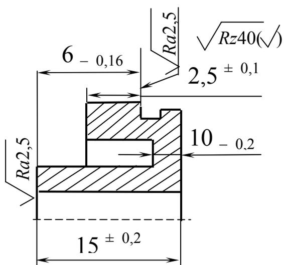
**Дано:** чертеж (эскиз) детали и план обработки (фрагмент). **Представить** технологический процесс в виде математической модели (в графической и аналитической формах) и **определить** операционные размеры  $l_1, l_2, l_3, l_4, l_5, l_6, l_7, l_8$ , обеспечивающие размеры детали, указанные на чертеже.
