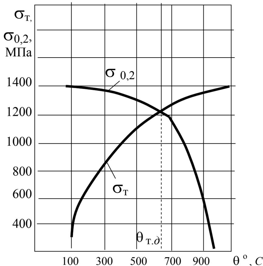
Рис. 3.1. Температурные зависимости  $\sigma_T$  и  $\sigma_{0,2}$  для никелевого сплава ХН77ТЮР. Значения  $\sigma_{0,2}$  даны для упрочненного деформацией сплава при испытании на сжатие
