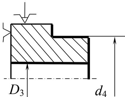
Допускаемое радиальное биение поверхностей  $D_3$  и  $d_4$  относительно базы  $T_{B5}'$  и  $T_{B5}''$
