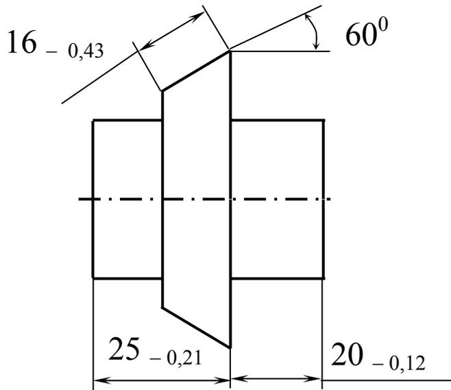
**Дано:** чертеж (эскиз) детали и план обработки (фрагмент). **Представить** технологический процесс в виде математической модели (в графической и аналитической формах), **выбрать** наиболее приемлемый вариант и **определить** операционные размеры  $l_1$ ,  $l_2$ , и  $l_3$ , обеспечивающие размеры детали, указанные на чертеже.
