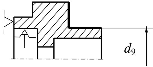
Допускаемое радиальное биение поверхности  $d_9$
