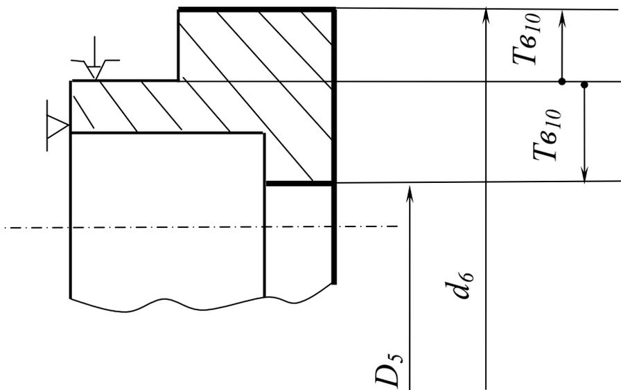
Допускаемое радиальное биение поверхностей  $D_5$  и  $d_6$  относительно базы  $T_{в10} = \dots$
