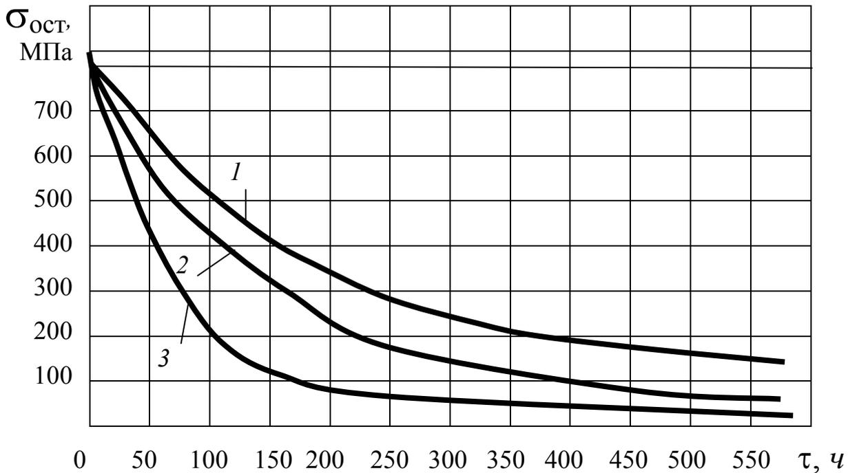
Рис. 3.3. Влияние условий испытания (эксплуатации) на релаксацию остаточных осевых напряжений в никелевом сплаве XN77TiOY;
