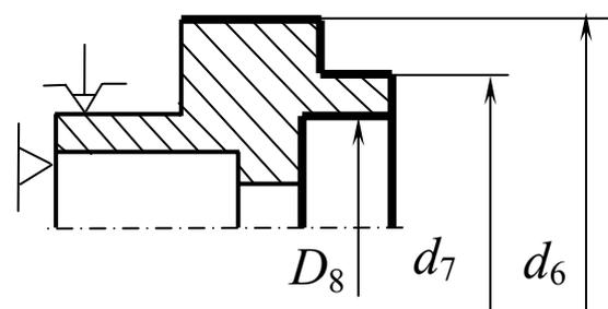
Допускаемое радиальное биение поверхностей  $d_6$ ,  $d_7$  и  $D_8$  относительно базы  $T_{v_{10'}}$ ,  $T_{v_{10''}}$  и  $T_{v_{10'''}}$ . (см. продолжение)
