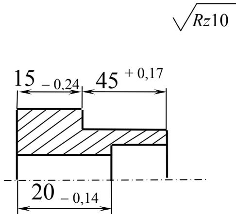
**Дано:** чертеж (эскиз) детали и план обработки (фрагмент). **Представить** технологический процесс в виде математической модели (в графической и аналитической формах) и **определить** значения технологических размеров  $l_1$ ,  $l_2$ ,  $l_3$  и  $l_4$ , обеспечивающих размеры детали, указанные на чертеже.
