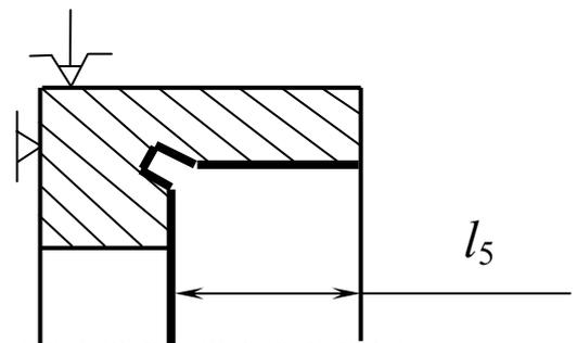
Примечание. При выдерживании размера  $l_5$  припуск не более 0,2 мм.
