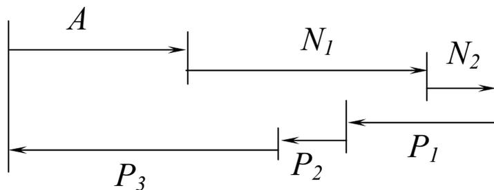
Рис.1.1. Схема размерной цепи
