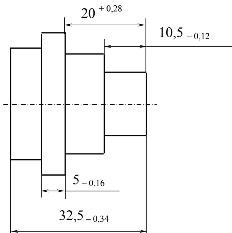
Рис.1.2. Чертеж (эскиз) детали<sup>1</sup>
