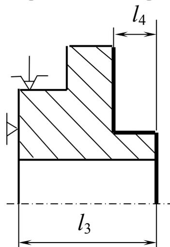
Примечание: при выдерживании размера  $l_4$  максимальное значение припуска 0,2 мм.
