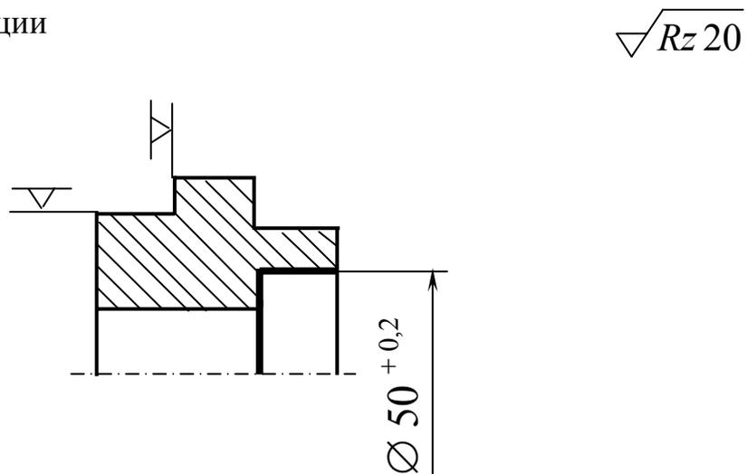
При установке заготовку выверить по обрабатываемой поверхности, допуская биение не более 0,15.
