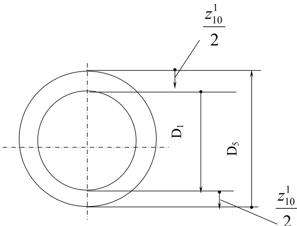
Рис. 1.37. Схема размерной цепи для определения  $D_1$  заготовки
