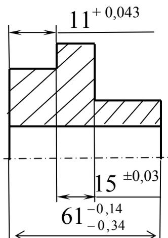
Дано: чертеж (эскиз) детали и план обработки в двух вариантах (фрагмент). Представить технологический процесс в виде математической модели (в графической и аналитической формах), выбрать наиболее приемлемый вариант технологии и **определить** операционные размеры  $l_1, l_2, l_3, l_4, l_5$  и  $l_6$ , обеспечивающие размеры, указанные на чертеже детали.
