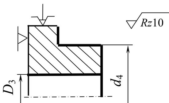
Допускаемое радиальное биение поверхностей  $D_3$  и  $d_4$  относительно базы  $Tv'_5$  и  $Tv''_5$
