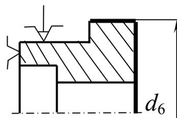
Допускаемое радиальное биение поверхности  $d_6$  относительно базы  $T_{v_{10}}$ .
