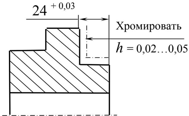
Дано: чертеж (эскиз) детали и план обработки (фрагмент). Представить технологический процесс в виде математической модели (в графической и аналитической формах) и определить значения технологических размеров  $l_1$ ,  $l_2$ ,  $l_3$ , обеспечивающих конструкторские размеры, указанные на чертеже детали.
