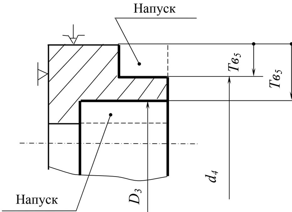
Допускаемое радиальное биение поверхностей  $D_3$  и  $d_4$  относительно базы  $T_{в5} = \dots$
