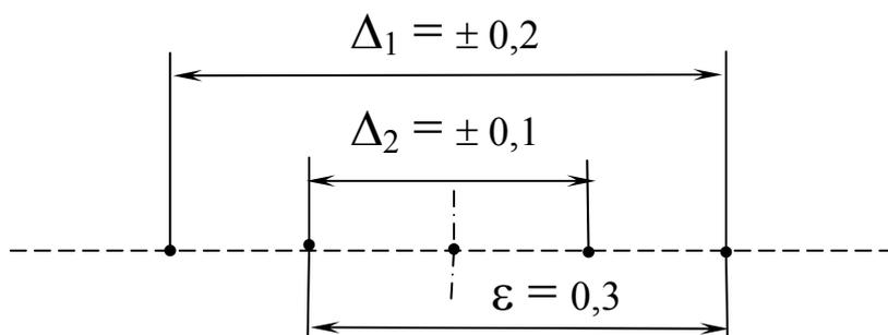
Рис. 1.28. К методике определения биения цилиндрических поверхностей
