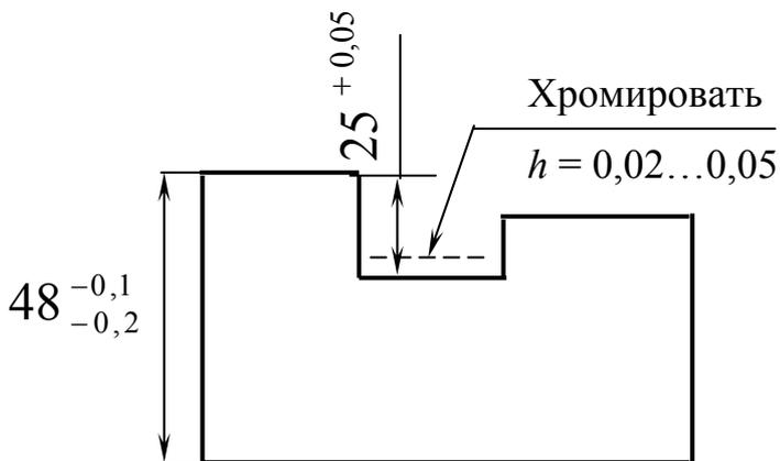
**Дано:** чертеж (эскиз) детали и план технологического процесса (фрагмент).
