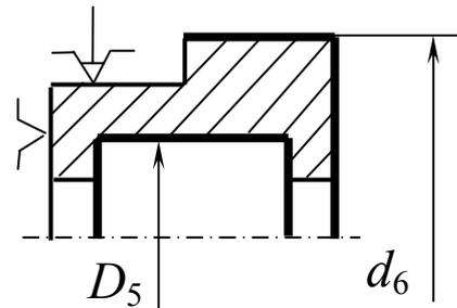
Допускаемое радиальное биение поверхностей  $D_5$  и  $d_6$  относительно базы  $T_{B10}'$  и  $T_{B10}''$
