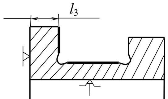
Примечание. Снимаемый припуск  $Z_{25\max} = 0,2$  мм
