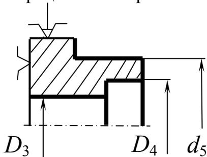
Допускаемое радиальное биение поверхностей  $D_3$ ,  $D_4$  и  $d_5$  относительно базы  $T_{v_5}'$ ,  $T_{v_5}''$  и  $T_{v_5}'''$ .
