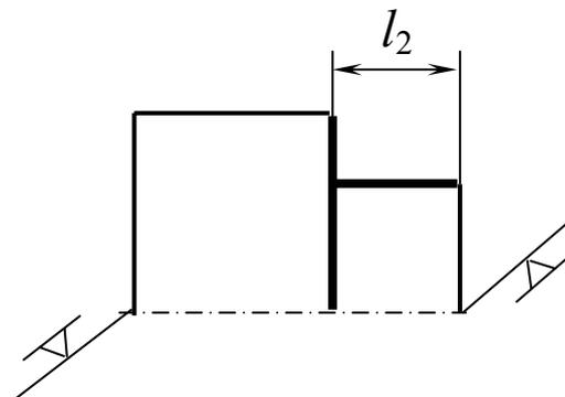
Примечание. При выдерживании размера  $l_2$  припуск не должен превышать  $0,15$  мм.
