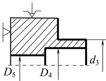
Допускаемое радиальное биение поверхностей  $d_3$ ,  $D_4$  и  $D_5$  относительно базы  $T_{v_5'}$ ,  $T_{v_5''}$  и  $T_{v_5'''}$ .
