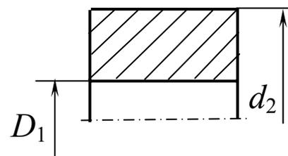
Допускаемое радиальное биение поверхностей  $D_1$  и  $d_2$  -  $T_{B0}$ .
