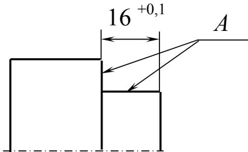
Поверхность  $A$  цементировать на глубину  $0,6 \dots 0,9$
