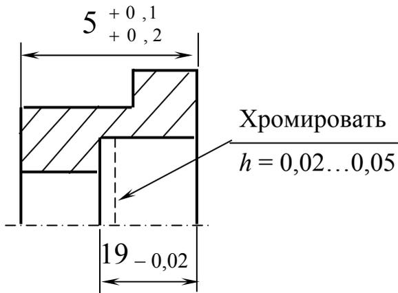
**Дано:** чертеж (эскиз) детали и план обработки (фрагмент). **Представить** технологический процесс в виде математической модели (в графической и аналитической формах) и **определить** значения технологических размеров  $l_1$ ,  $l_2$ ,  $l_3$ ,  $l_4$  и  $l_5$ , обеспечивающих размеры, указанные на чертеже детали.
