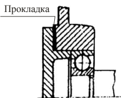
Рис. 3.7. Регулировка зазора в подшипнике металлическими прокладками
