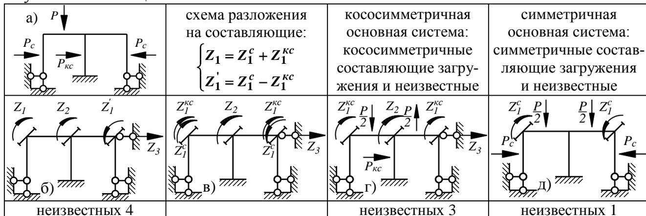
**Рисунок 11.2. Схема группировки неизвестных метода перемещений**
