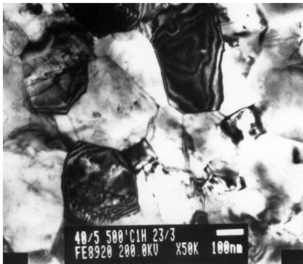
Рис. 19. структура СМК железа после интенсивной деформации и отжига
