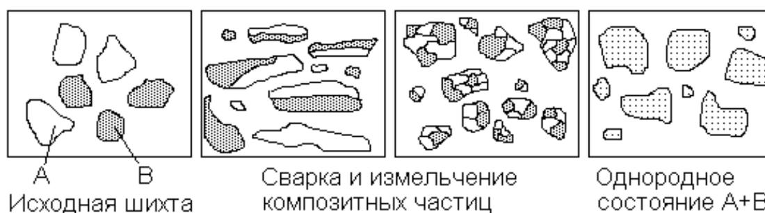
Рис. 17 . Последовательные стадии механического легирования
