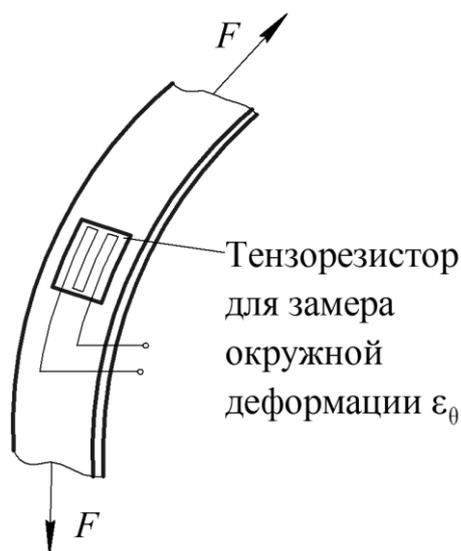
**Рис. 5.1.** Схема замера окружной деформации  $\varepsilon_\theta$
