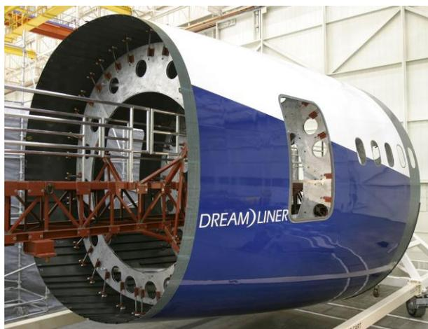
**Рис. 2.** Секция цельного полномасштабного композитного фюзеляжа для Boeing-787
