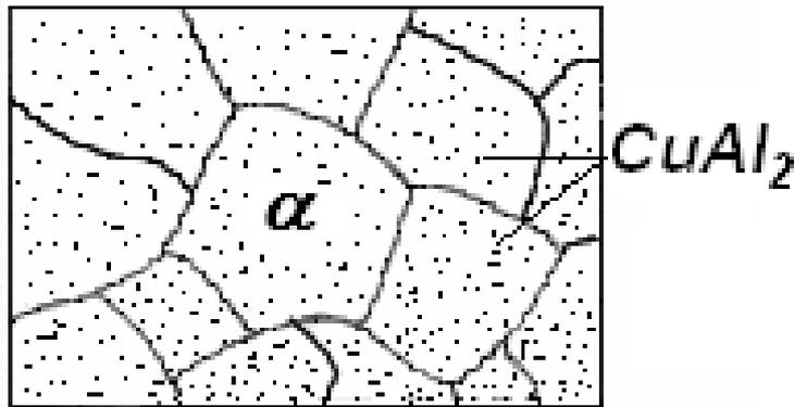
При выдержке закаленного сплава, в пересыщенном  $\alpha'$  - твердом растворе происходит диффузионное перераспределение атомов меди с формированием мелкодисперсных (30 нм) частиц  $\text{CuAl}_2$ .
