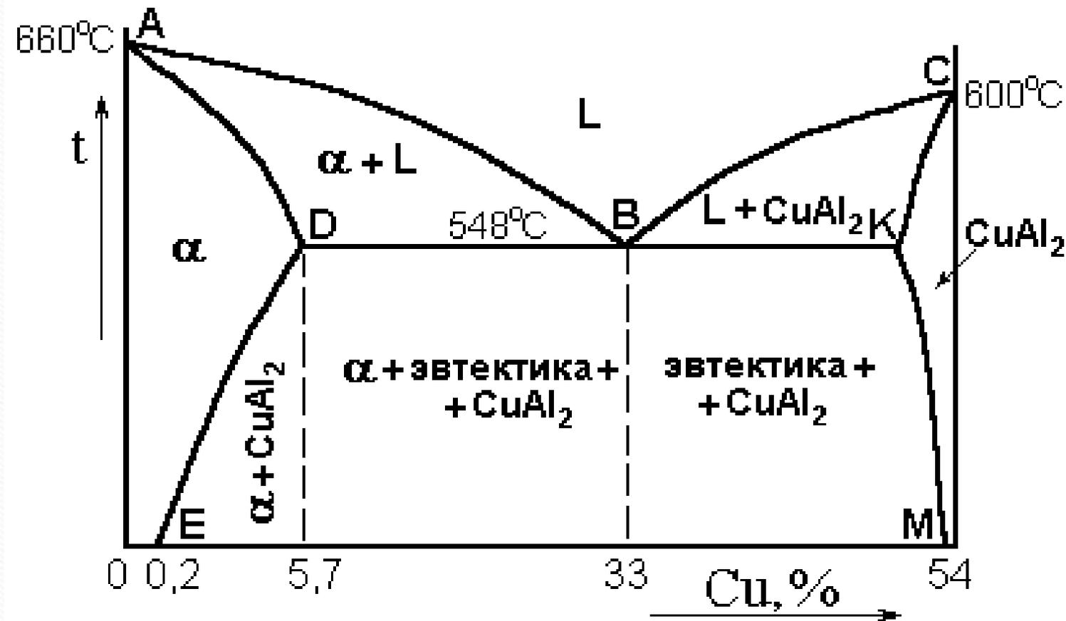
Дуралюмин – сплав алюминия с 4-5 % меди
