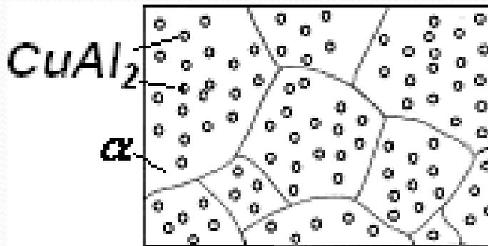
В отожженном – равновесном состоянии структура дуралюмина состоит из зерен твердого раствора меди в алюминии и частиц соединения  $\text{CuAl}_2$ . При этом частицы  $\text{CuAl}_2$  крупные.
