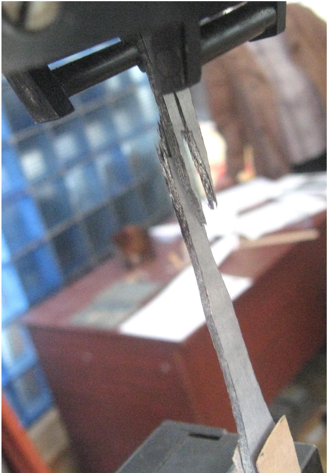
Рис. 4. Образцы после механических испытаний: комбинированное разрушение
