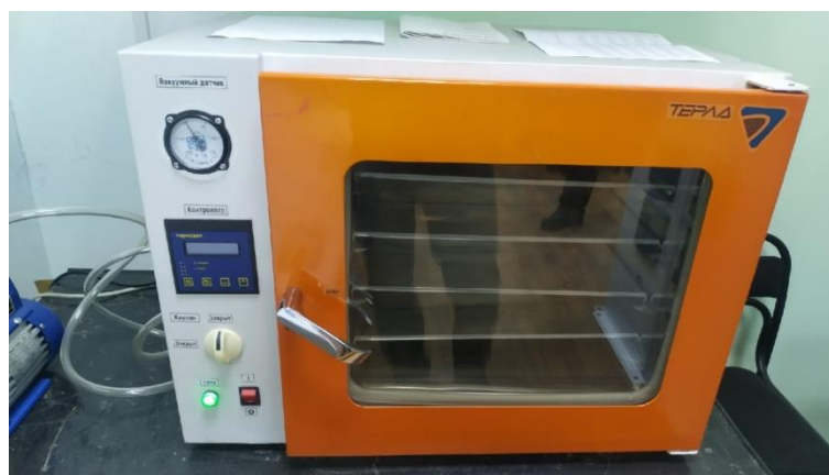
Рис. 4.1. Печь для удаления замасливателя с углеродной ткани
