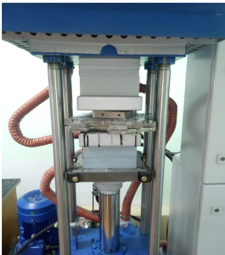
Рис. 2.1. Гидравлический пресс с нагревательными плитами
