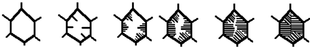
Рис. 5.4. Схема роста перлитных колоний.
