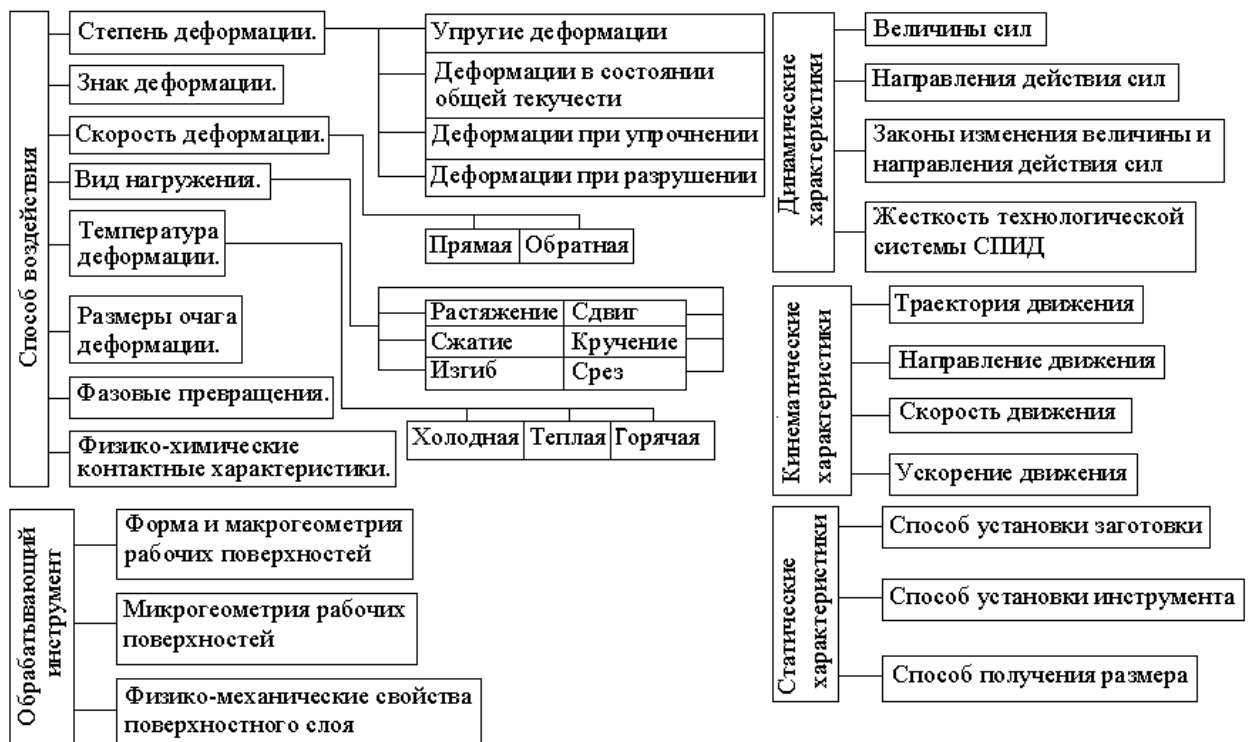
Рис. 19. 2. Структура подсистем: «Способ воздействия», «Обрабатывающий инструмент», «динамические, кинематические и статические характеристики».
