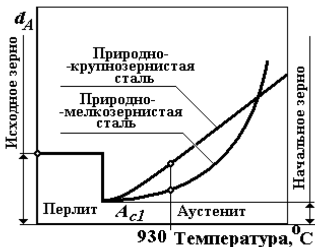
Рис. 5.2. Схема роста зерна в природно-крупнозернистых и природно-мелкозернистых сталях при нагреве: d_A – размер зерна; A_{c1} – температура начала фазовой перекристаллизация перлита.
