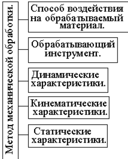
Рис. 19. 1. Технологическая структура метода механической обработки.
